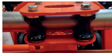
Dubbla rullar säkerställer en enkel sidoförskjutning.
