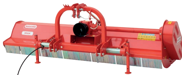
Sidoförskjutning görs lätt på röret.
